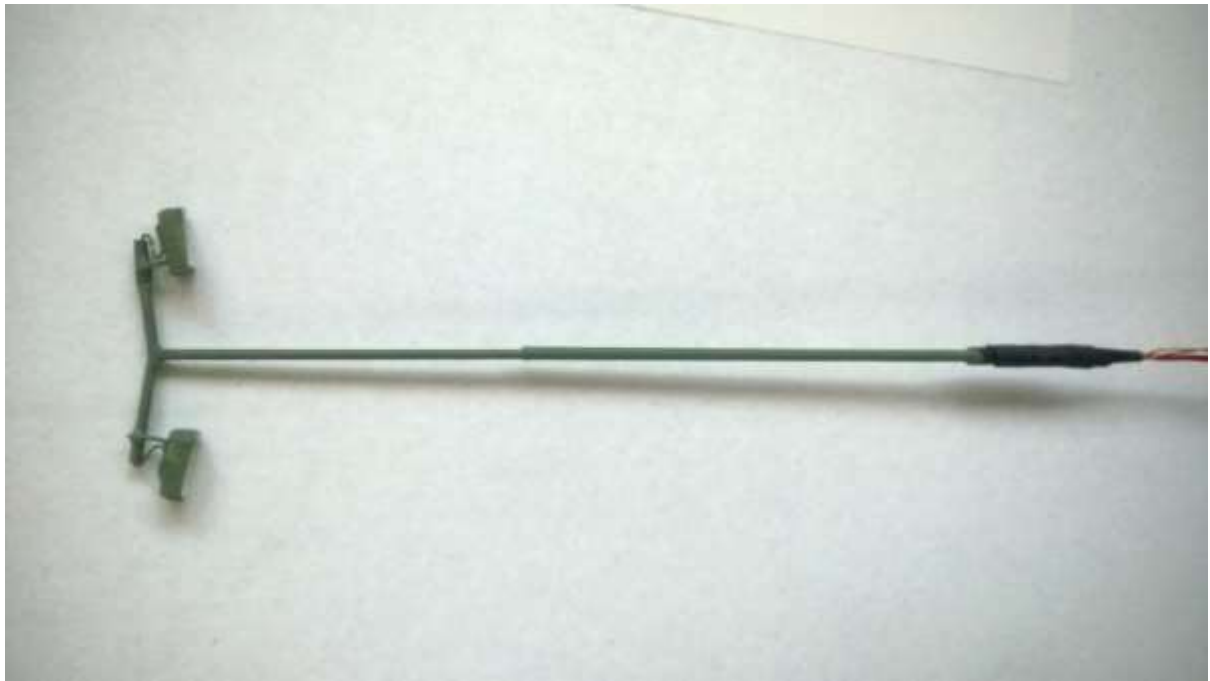
Eindresultaat, de dunne draadjes en het deel wat in de baan valt zijn van krimpkous voorzien...
